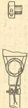
Рис. 2. Контролька штуцера в карбюраторе, предложенная А. Захарьяным из г. Кривой Рог, просверлившего для этого отверстие диаметром 1 мм между гравиями пробы, закрывающей фильтр.
