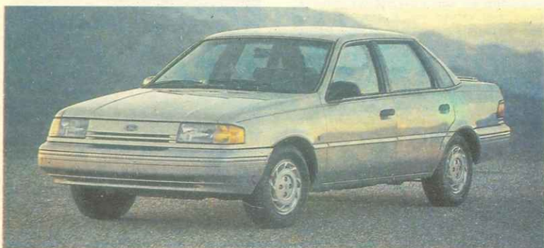
«Форд-темпо-ЛХкс» [здесь и далее приводятся следующие данные: число цилиндров — рабочий объем, мощность, длина, масса в снаряженном состоянии, наибольшая скорость]: 4 — 2307 см 3 , 99 л.с./72,8 кВт, 4490 мм, 1179 кг, 165 км/ч. Аналог нашего ГАЗ-24-10.
